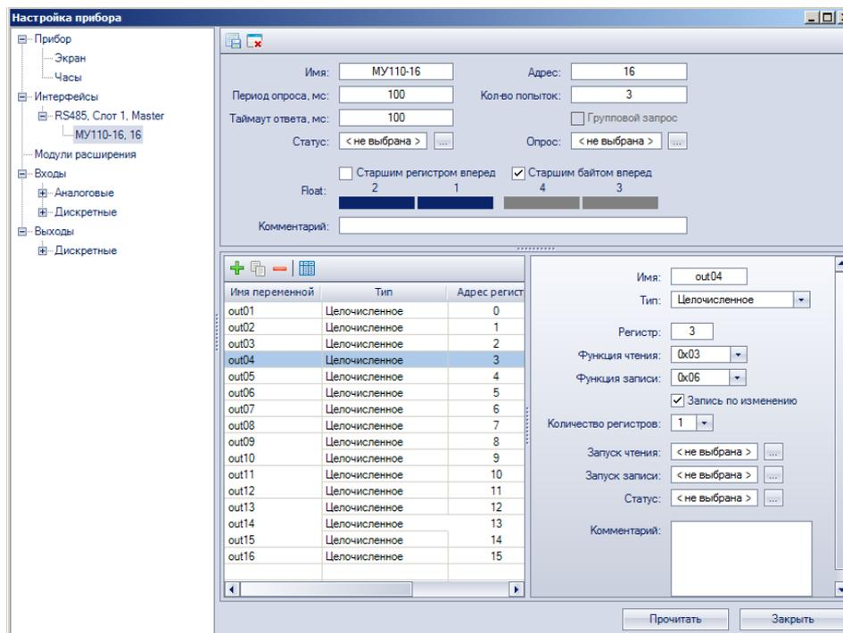
Рисунок 3 – Пример настройки выходных сетевых переменных дискретных модулей
