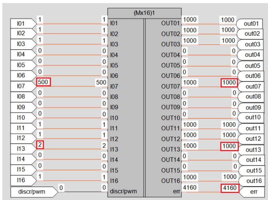
Рисунок 4 – Пример работы макроса в дискретном режиме
