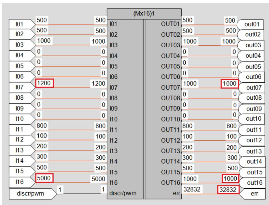
Рисунок 5 – Пример работы макроса в режиме ШИМ
